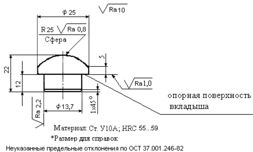
Рисунок 20 – Верхний вкладыш
